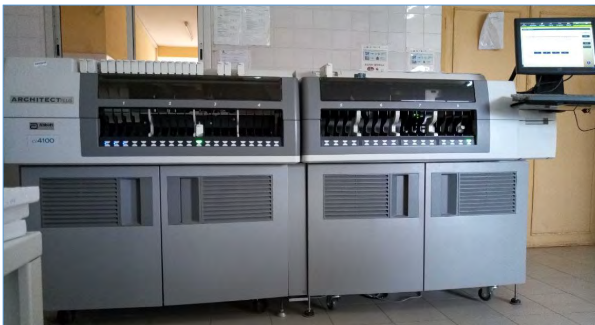
Figure 9: Automate d'immunoanalyse intégré Architect ci 4100 (Abbott Diagnostics, USA) au LBM HOGGY
