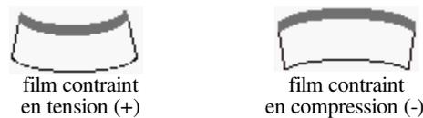
**Figure A.II.1 :** Courbure convexe et courbure concave d'un substrat après dépôt
