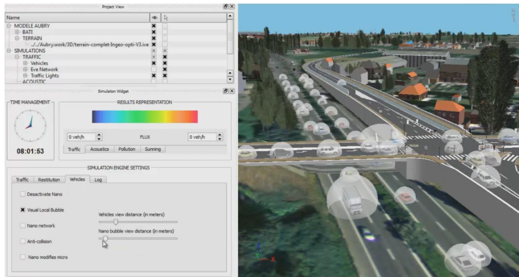
Figure 21: Interfaçage trafic / maquette numérique urbaine à différentes échelles de représentation (logiciel eveCity + SYMUVIA)
