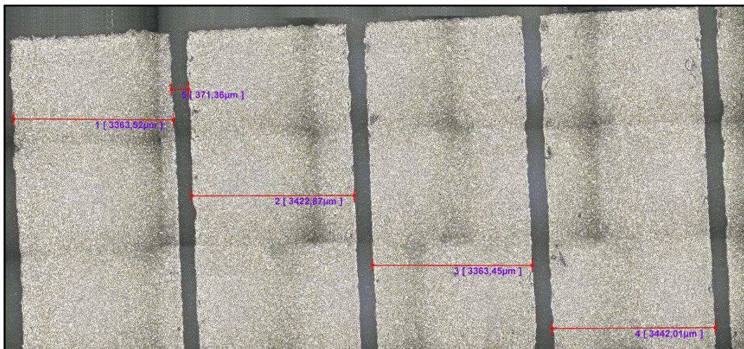
Figure II-10 : Photographie au microscope électronique de l'électrode fractionnée
