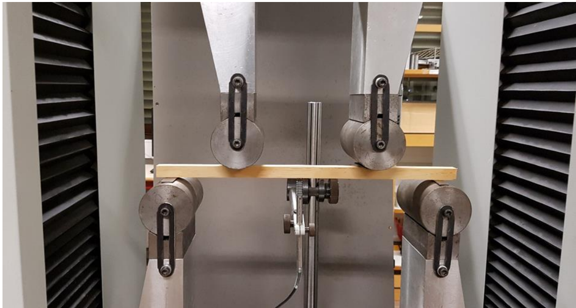
Figure II.13: Essai de flexion 4 points sur éprouvettes de pin
