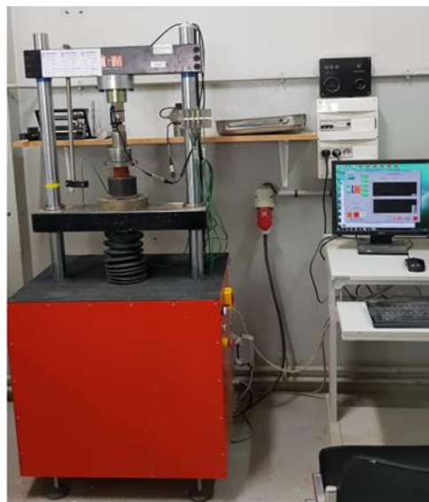
Figure III.3: Essai de compression sur les éprouvettes cylindriques
