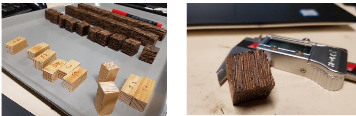
Figure II.10: Échantillons des deux essences de bois pour les mesures de masse volumique et de teneurs en eau (le rônier est le bois de couleur sombre)
