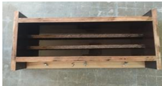
Figure IV.9: Préparation des moules des poutres en béton de terre armé de bois
