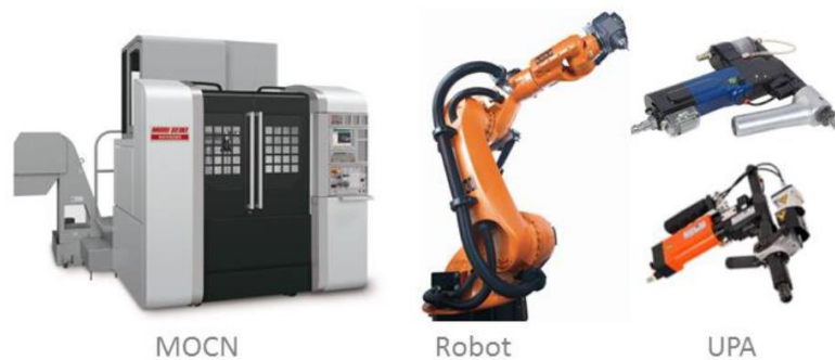
Figure 1-12 : Machines industrielles de perçage (Ladonne, 2016)
