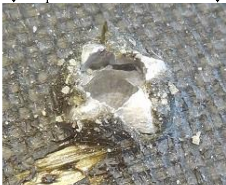
Figure III-40 : Zones impactées d'une protection tricotée AA6-AdC250-TB12 impactée par un projectile D6.35-WC-Conique à 441 m/s avec le lanceur Ø60. Gauche : Faces avant (haut) et arrière (bas) de la plaque avant en alliage d'aluminium. Droite : Faces avant (haut) et arrière (bas) du panneau de tissu balistique arrière.
