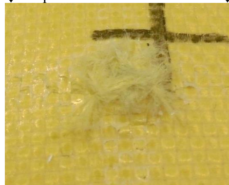
Figure III-40 : Zones impactées d'une protection tricotée AA6-AdC250-TB12 impactée par un projectile D6.35-WC-Conique à 441 m/s avec le lanceur Ø60. Gauche : Faces avant (haut) et arrière (bas) de la plaque avant en alliage d'aluminium. Droite : Faces avant (haut) et arrière (bas) du panneau de tissu balistique arrière.
