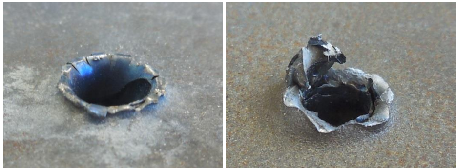
Figure III-27 : Faces avant (gauche) et arrière (droite) d'une protection MS8.8 impactée par un projectile D6.35-WC-Conique à 714 m/s avec le lanceur Ø60
