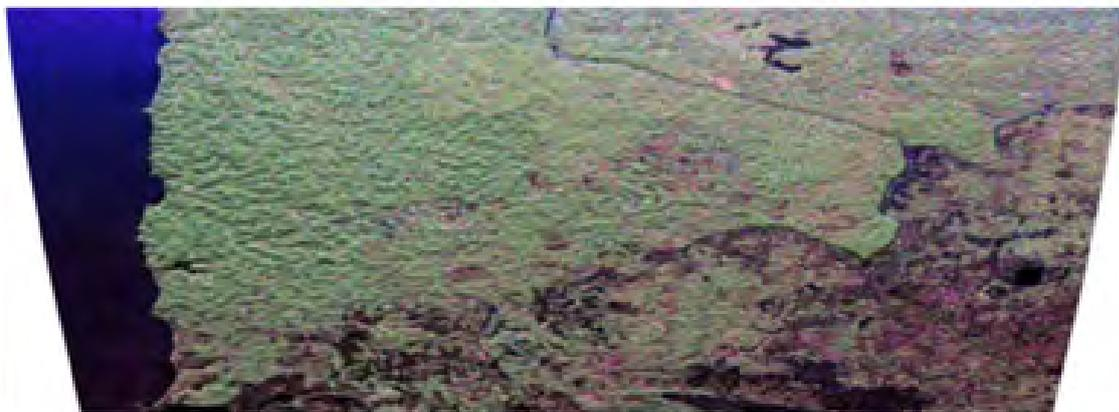
FIGURE 2.7 – Superposition des images bande P acquises sur le site de Mondah en fausses couleurs (Rouge : HH, Vert : HV, Bleu : VV). Axe azimutal horizontal et axe vertical en range. Extrait de [11].
