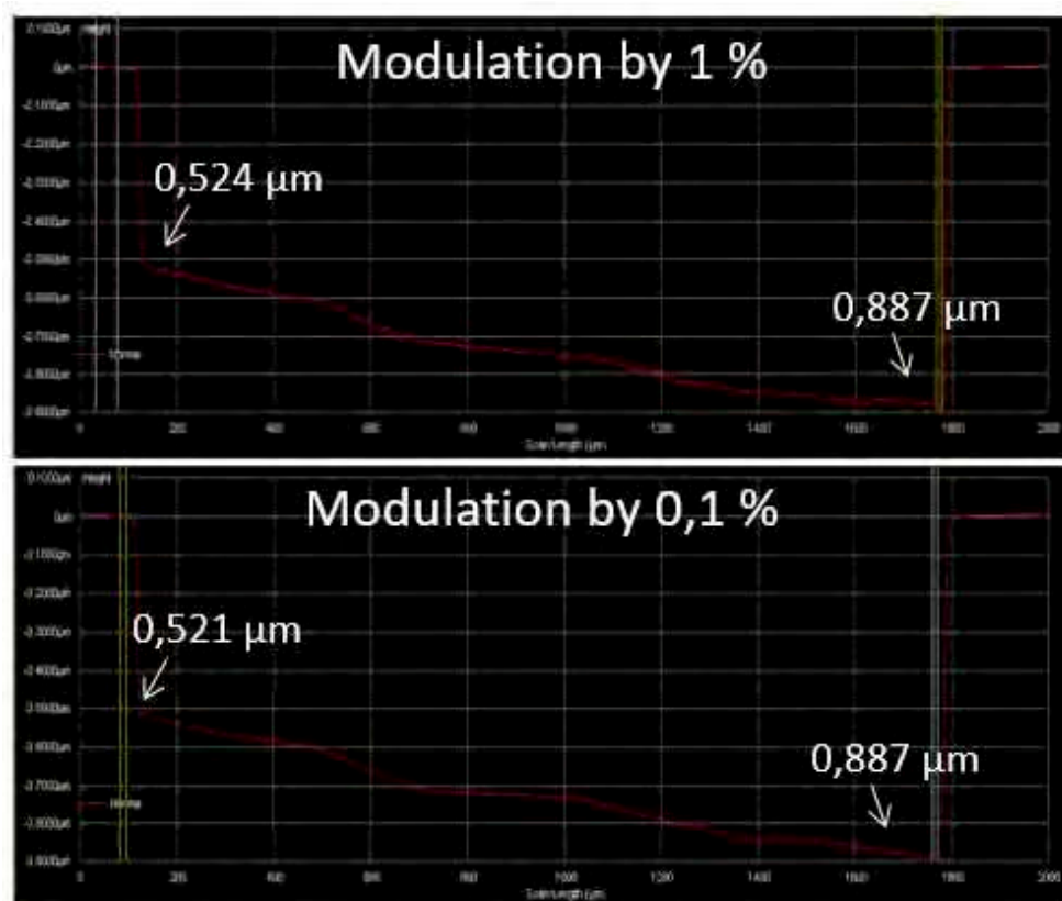
Figure 2.27 Différence entre des pentes réalisées avec un pas de modulation de 1 % et de 0,1 %.
