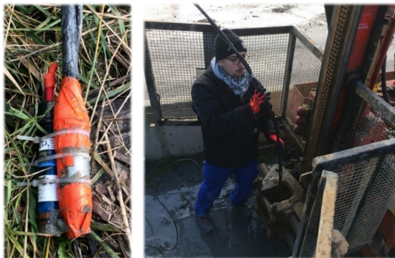
Figure III-12 Électrode de référence \text{Cu} - \text{CuSO}_4 montée sur perche semi-rigide (à gauche) et mesure de potentiel en fond de forage (à droite)
