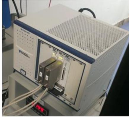
**Figure 55 : Module d'acquisition des données PXI**
