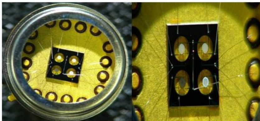
**Figure 34 : Exemple d'un multi capteur développé au LAAS**
