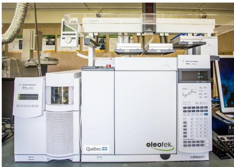
Figure 3 : Chromatographie en phase gazeuse couplée avec une spectrométrie de masse [43]
