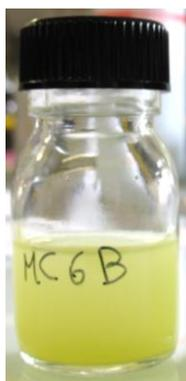
Figure 45 : Suspension de plaquettes de  $H_2WO_4$  dans l'eau
