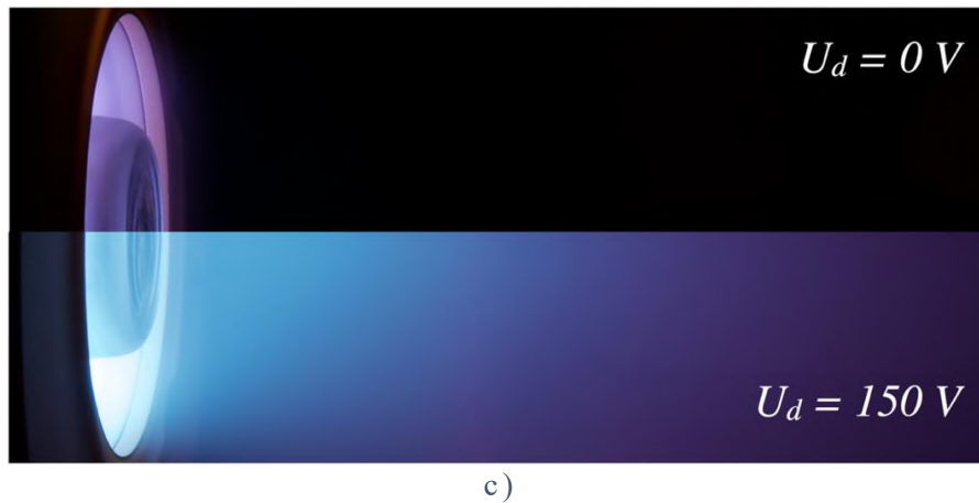
c) Figure 86 : a) Hystérésis sur le courant de décharge en fonction de la tension de décharge appliquée, P_{abs} = 70 \text{ W} . b) Évolution du potentiel de cathode V_{cath} en fonction de la tension U_d pour différentes puissances RF absorbées par le plasma. c) Image comparative du propulseur fonctionnant à tension nulle, U_d = 0 \text{ V} , P_{abs} = 70 \text{ W} , I_d = 0 \text{ A} et à plus forte tension, U_d = 150 \text{ V} , P_{abs} = 70 \text{ W} , I_d = 0,60 \text{ A} . Le temps d'exposition est identique dans les deux cas. Débit de Xénon dans le propulseur Q_{Xe} = 6 \text{ sccm} . Débit de Xénon dans la cathode Q_{Xe} = 1,5 \text{ sccm} .
