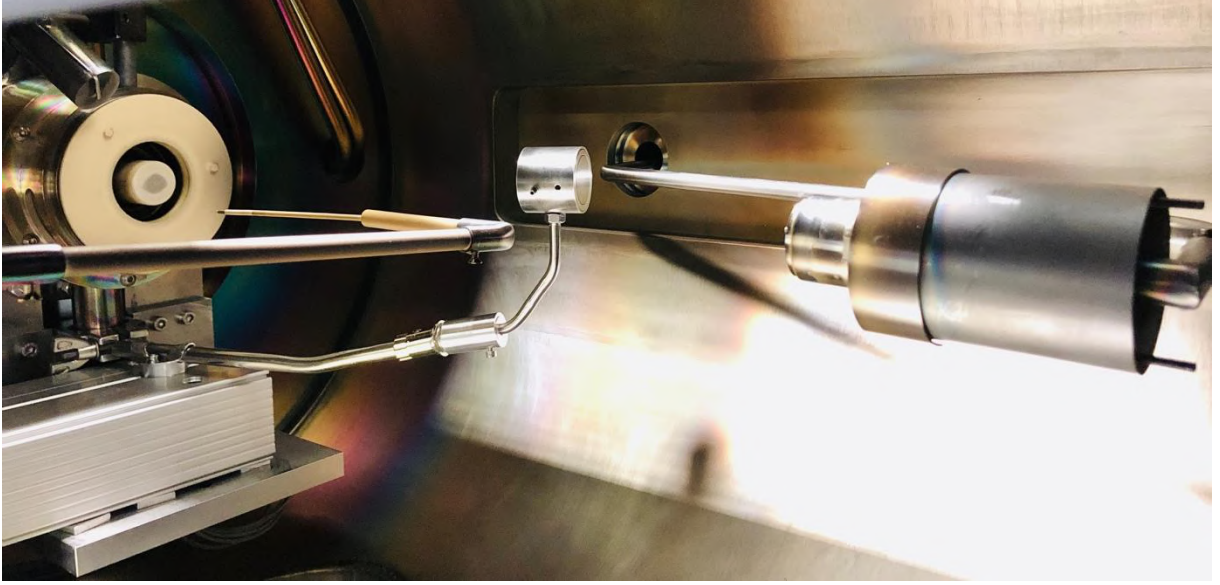
Figure 27 : Photographie du propulseur ID-Hall et de ses différents outils de mesures installés dans le caisson d'expérimentation (sonde de Langmuir, sonde de Faraday, sonde RPA)
