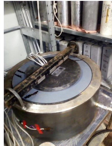
Figure III-9 : coupe de principe du dispositif de mise en charge des anneaux en béton et photo de l'ensemble une fois en place
