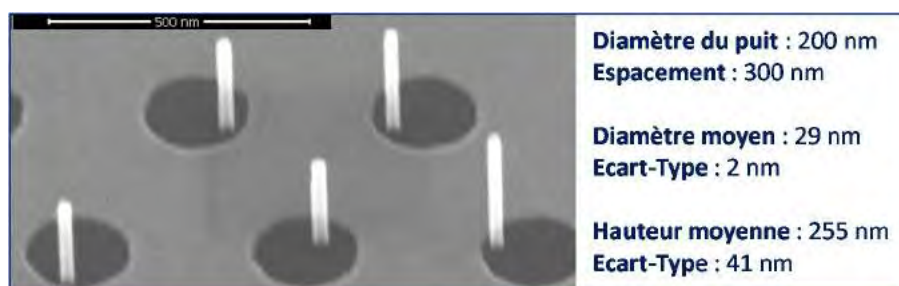
Figure II-38 : Image MEB d'une croissance de nanofil d'InAs pour un masque de croissance. Exemple de dimensions et dispersions obtenues sur un échantillon classique.
