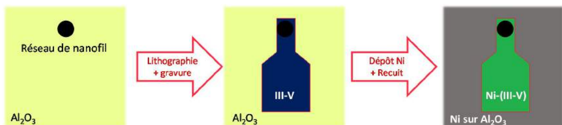
Figure V-26: Stratégie employée pour éviter un procédé "lift-off". L' \text{Al}_2\text{O}_3 est structuré par gravure pour bloquer la diffusion du Ni en dehors des contacts.
