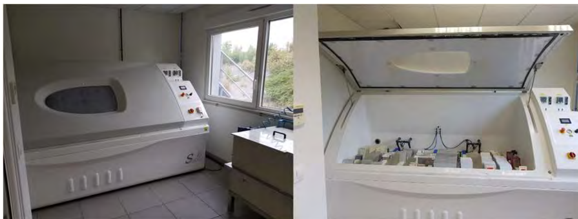
Figure 36 : Enceinte de corrosion accélérée sous brouillard salin neutre
