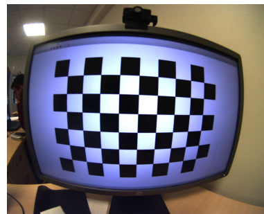
FIGURE 2.7 – Image d'un échiquier obtenue à partir d'une caméra fisheye.
