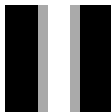
FIGURE 3.5 – Exemple de filtre de forme appliqué devant les photodiodes.
