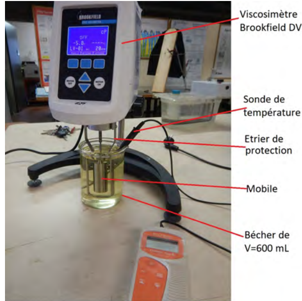
FIGURE 18 – Viscosimètre Brookfield DV1.
