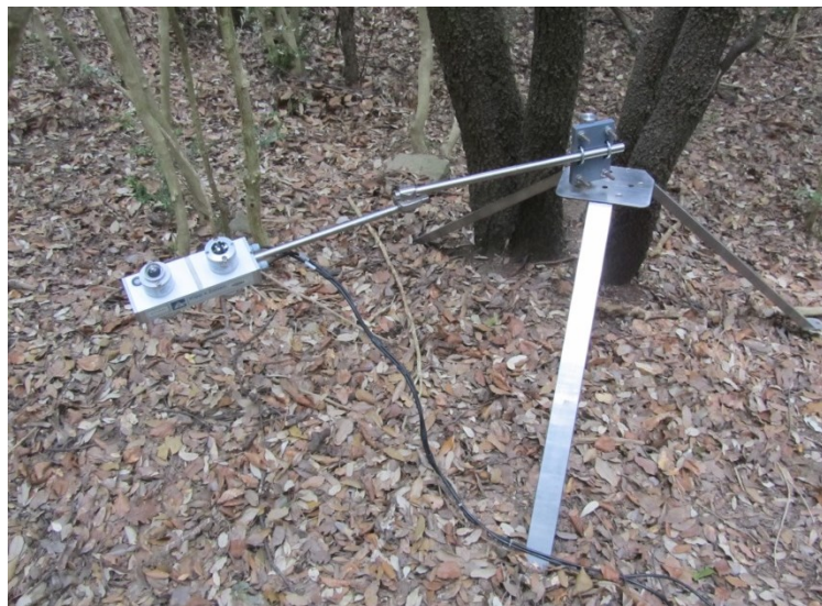
Figure IV-3 : Outil portatif construit afin de réaliser des mesures d'albédo du sol SW à l'aide d'un albédo-mètre CNR1 comportant un pyranomètre [0.3-3 \mu m].
