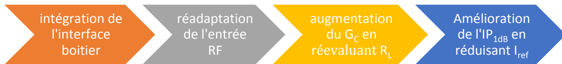
Figure 99 : étapes de réoptimisation du mélangeur en boîtier WLCSP
