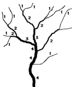
Figure 1 – Méthode d'ordination des cours d'eau selon Strahler. La hiérarchie fluviale selon la méthode d'ordination de Strahler (1957) se manifeste par l'importance croissante de ces éléments depuis l'amont avec les plus petits tributaires d'ordre 1 dont l'union forme un cours d'eau d'ordre 2 et ainsi de suite ; le numéro d'ordre croît avec la taille du bassin, le nombre de tributaires et la densité de drainage jusqu'à former les plus grands fleuves.
