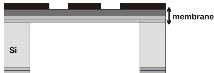
Figure II.10. Topologie de la ligne CPW sur membrane
