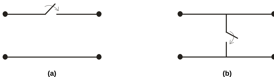
Figure IV.1. Schéma illustrant un commutateur placé dans une configuration (a) séries ou (b) parallèle
