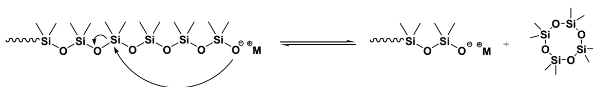
Figure 1 : Polymérisation par ouverture de cycle de D 4
