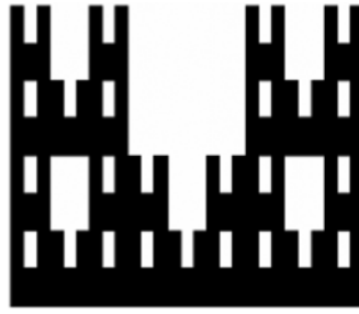
Figure I.10 Exemple d'une antenne fractale self-affine à l'itération 3 (Version plaquée)
