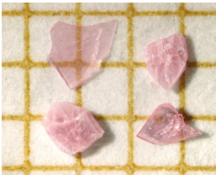
Fig. IV.3. Cristaux synthétisés à partir d'une poudre de \text{Nd}_{0.66}\text{Pb}_{0.17}\text{Th}_{0.17}\text{PO}_4 dans un flux au plomb. Les plus gros cristaux sont représentés ici. La grille est de 1 \times 1 \text{ mm}^2 .
