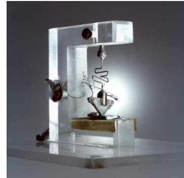
Reproduction du premier transistor réalisé en 1947 dans les laboratoires « BELL Labs ».
