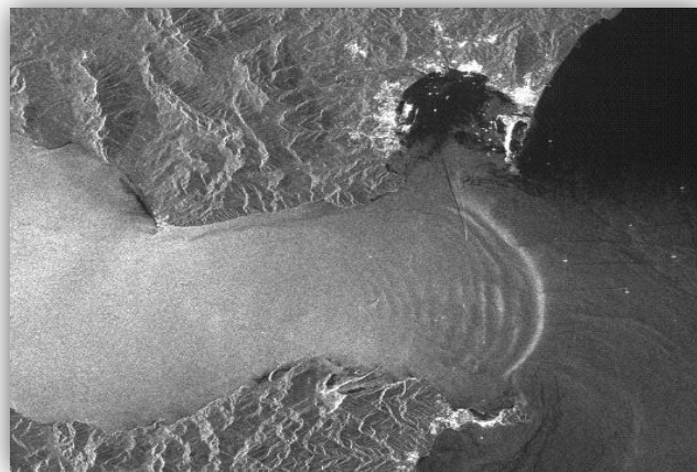
Figure 1.7 : Trace d'un paquet d'ondes internes générées par la marée au-dessus du détroit de Gibraltar, se propageant vers le bassin méditerranéen (source : RADARSAT image, Space Department, DERA, UK).
