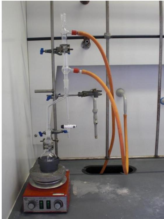
Figure 11: Appareillage par reflux de Dean-Stark
