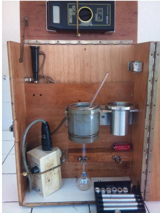
**Figure 10: Photographie des divers constituants du viscosimètre à écoulement Geserco**
