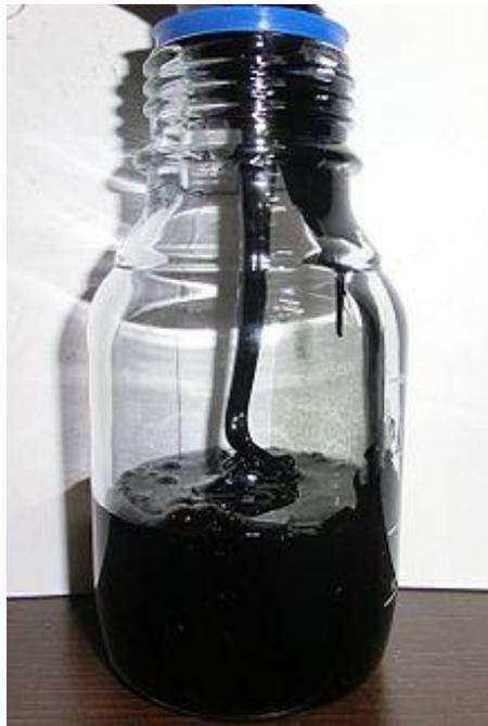
**Figure 6: Photographie d'un échantillon de la fraction pétrolière fuel-oil lourd**
