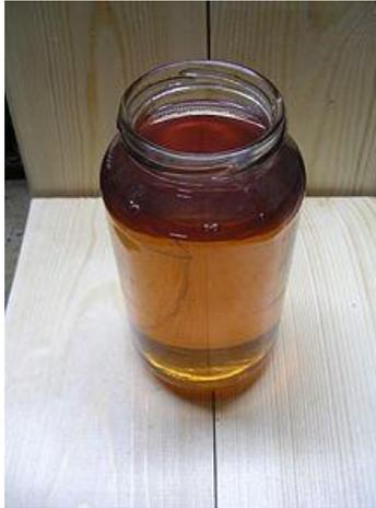
Figure 5: Photographie d'un échantillon de la fraction pétrolière gazole
