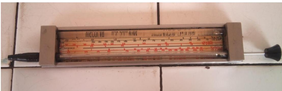
**Figure 9: Photographie du viscosimètre à chute de bille**
