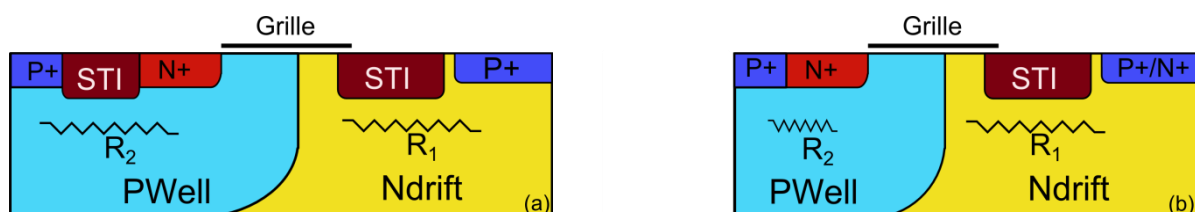
Figure 4.34: Structure mixte de type SBO (a) et SBC (b), avec R1 la résistance de la région N-drift et R2 celle de la région Pwell
