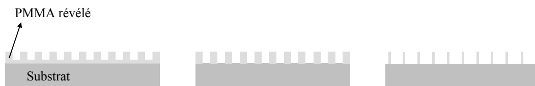
Figure A1.8: réseaux de lignes après révélation. A gauche: réseau sous-révé (ou sous-insolé). Au centre: réseau correctement dosé et révé. A droite: le réseau est quasiment sur-révé (ou sur-insolé; les murs de résine restant sont fins et fragiles).
