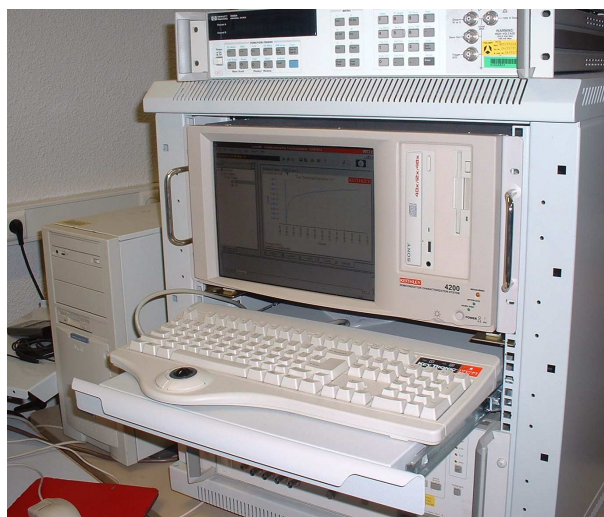
FIG. 21 – Equipement de caractérisation utilisé pour les mesures électriques (Modèle 4200 Keithley)
