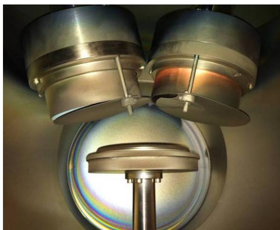
Figure 41. Photo de l'intérieur de l'enceinte de dépôt par pulvérisation cathodique magnétron 19 du LAAS. Visualisation du porte substrat et des deux cibles masquées
