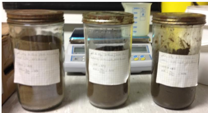
Figure 11 : Pots de stockage des échantillons de sols
