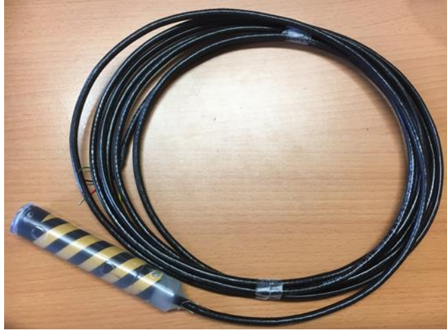
Figure 104 : Nouveau design du capteur surmoulé
