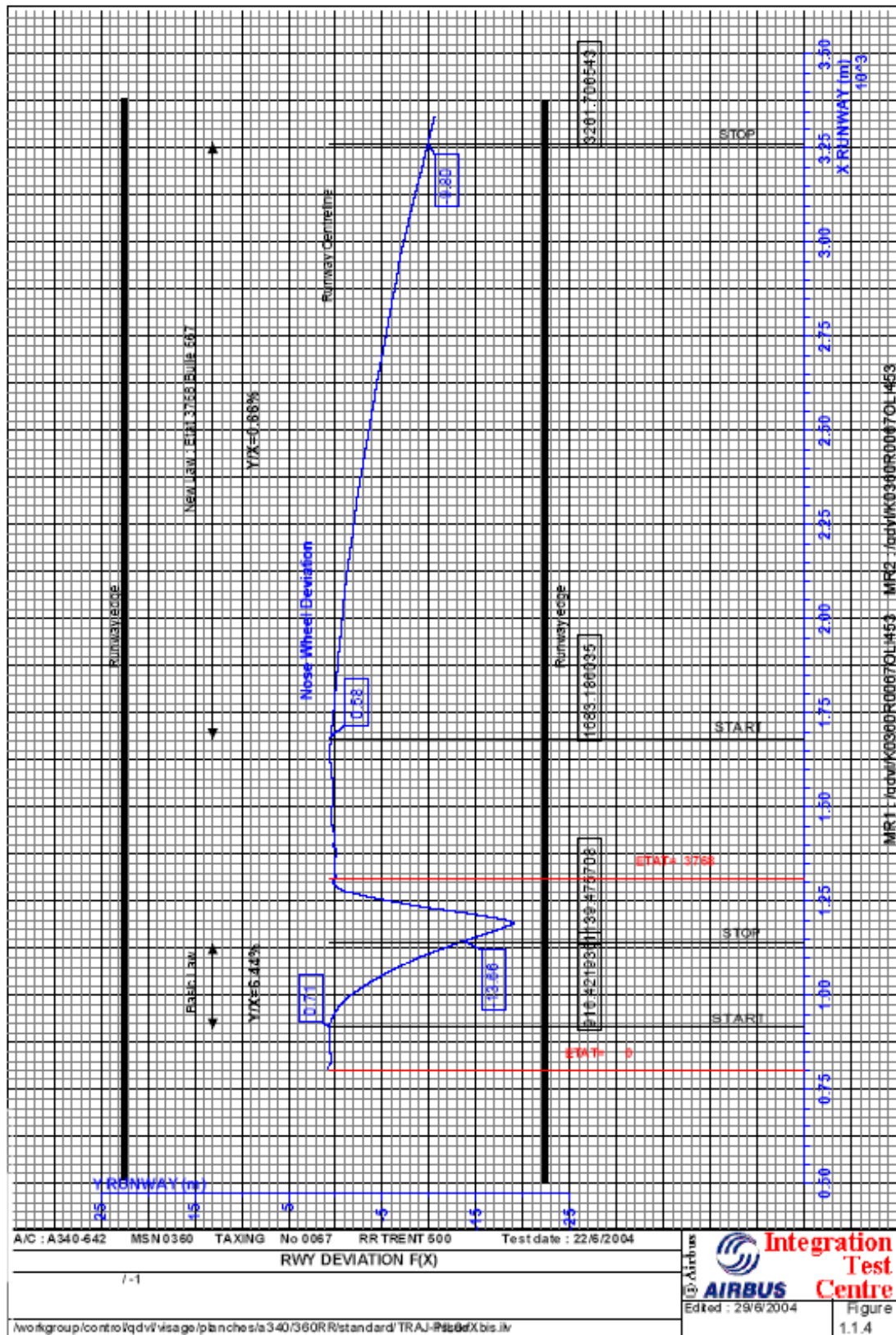
figure 4.14 : Tracé de l'écart latéral à l'axe de piste (référence GPS) en fonction de l'avancement de l'appareil – FCR T67 MSN 360 –.
