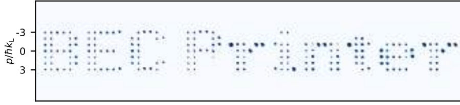
FIGURE 5.9 – Illustration d’une imprimante à atomes. Chaque colonne de cette image est une image expérimentale d’absorption après temps de vol d’une distribution en impulsion dont certains ordres sont peuplés de manière équiprobable entre les états d’impulsion (|-3\hbar k_L\rangle, \dots, |3\hbar k_L\rangle) par contrôle optimal.
