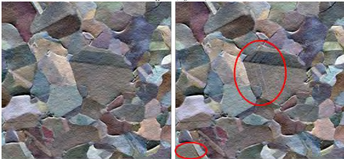
Figure II-39 : Exemple d'images FSD prises avant et après déformation d'un échantillon lors d'un essai de traction en MEB in-situ.
