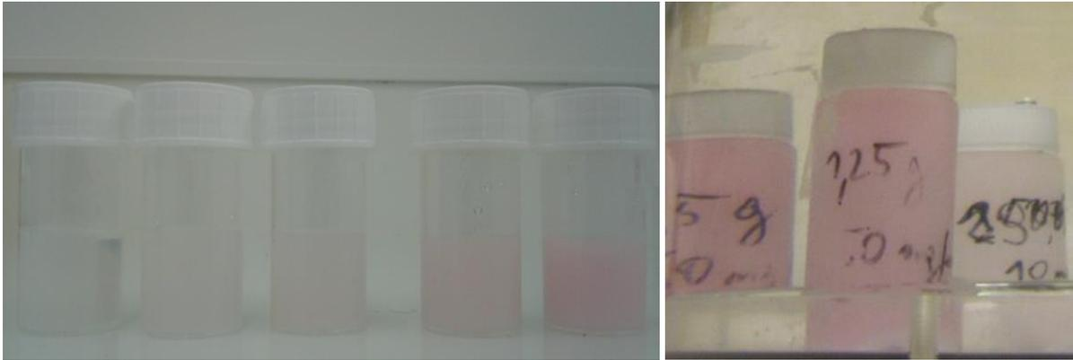
Figure 19 – Gamme de concentration d'holmium CRCT (à g.) et UMC Utrecht (à d.) avec la méthode du tube plein
