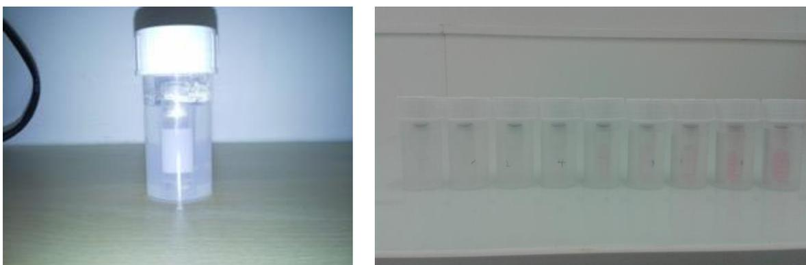
Figure 20 – Gamme de concentration d’holmium du CRCT avec la méthode du mini-tube
