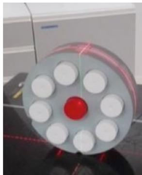
Figure 18 - Fantôme CIRS 62 partie tête avec les tubes d'holmium en place
