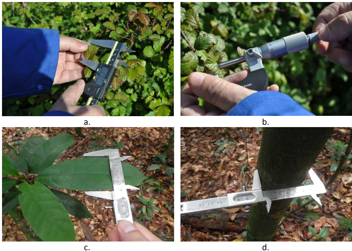
Figure 2-36 : Illustration de mesures des caractéristiques géométriques de la végétation. En haut il s'agit de mesures sur des ronces et en bas de mesures effectuées dans le sous bois d'une forêt tropicale. a. : mesure des dimensions d'une feuille à l'aide d'un pied à coulisse. b. : mesure de l'épaisseur d'une feuille avec un micromètre. c. : mesure des dimensions d'une feuille dans la forêt. d. : mesure du diamètre d'un tronc du sous bois.
