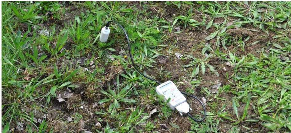
Figure 2-33 : Sonde d'humidité utilisée pour nos mesures d'humidité et de permittivité.
