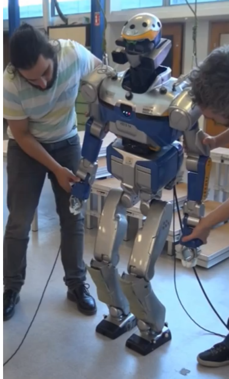
FIGURE 3.8 – Tests d'interaction avec HRP-2 contrôlé en couple
