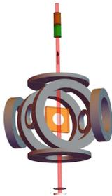
**Lancement et séquence d'interférométrie.** Lors de la dernière étape le nuage sera lancé vers l'enceinte d'interférométrie haute dans laquelle il sera diffracté par une série de pulses laser pour réaliser la séquence d'interférométrie. Les deux cylindres **orange** et **vert** représentent les électrodes qui seront utilisées pour la première expérience que nous voulons mener, le test de la neutralité de l'atome.
