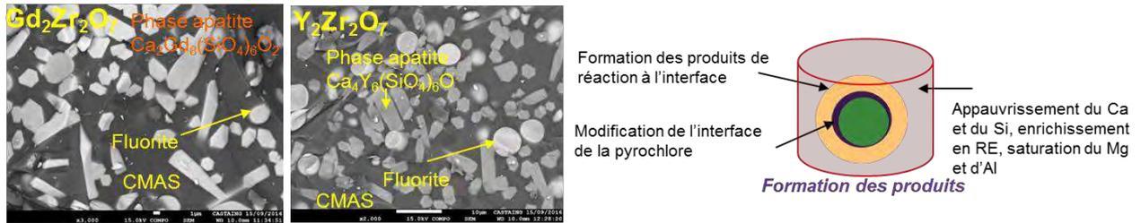
Figure 163 : Formation des produits dans le système anti-CMAS  $Gd_2Zr_2O_7$  et  $Y_2Zr_2O_7$
