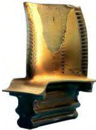
Figure 34 : Aube de turbine M-88 après attaque en service par les CMAS
