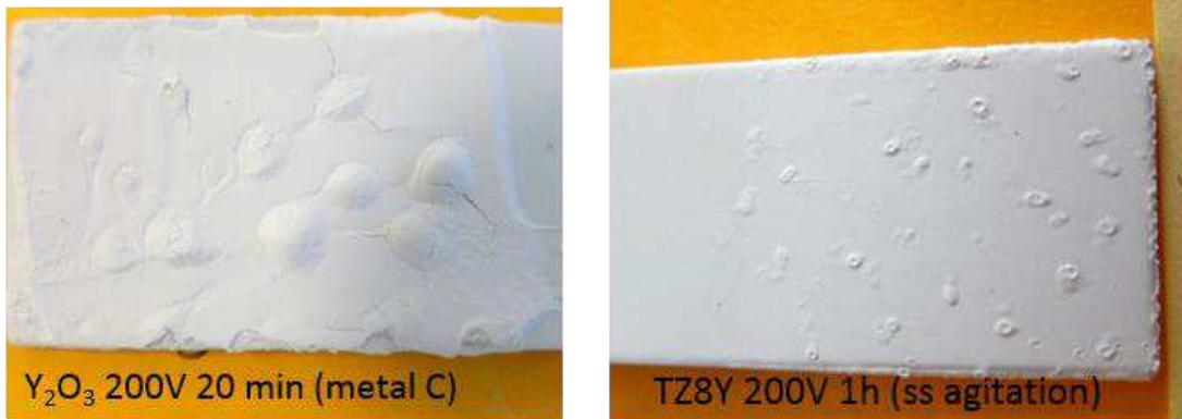
Figure 183 : a) Revêtement d'yttrine, b) revêtement d'YSZ réalisé par électrophorèse sur des barrières thermiques EBPVD
