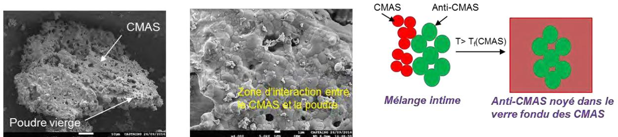
Figure 159 : Contact entre l'anti-CMAS et le CMAS
