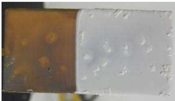
Figure 185 : Dépôt d'YSZ, de couleur blanche, réalisé par électrophorèse après métallisation à l'argent de couleur grise
