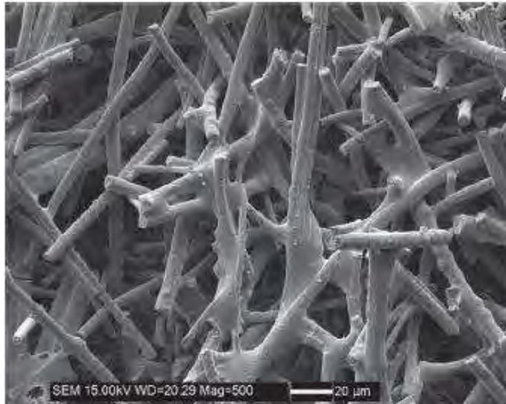
Figure 29 : Fibres d'YSZ utilisées pour réaliser une céramique [86]
