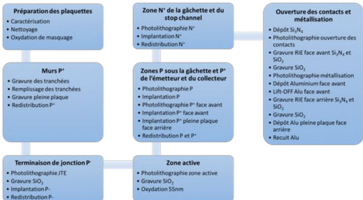
Figure III. 20 : Filière technologique de réalisation du BipAC sur substrat N
