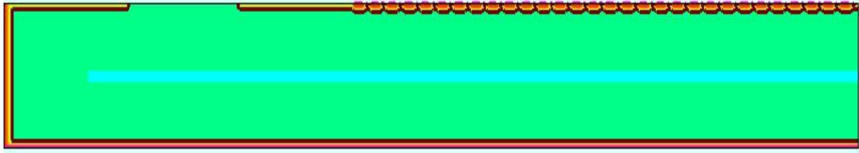
Figure II. 93 : Demi-puce du BipAC NPN avec la couche P enterrées dans le substrat P - et la périphérie
