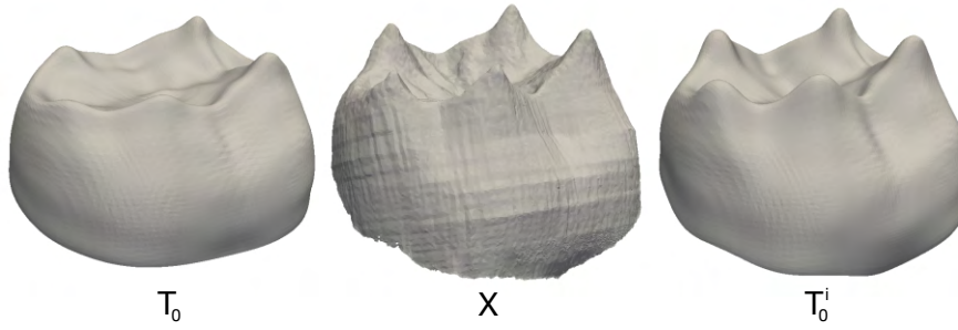
FIGURE 6.1 – Recalage utilisé dans la section 6.1. T_0 est la surface de référence, X est la surface cible et T_0^i est la surface de référence déformée.
