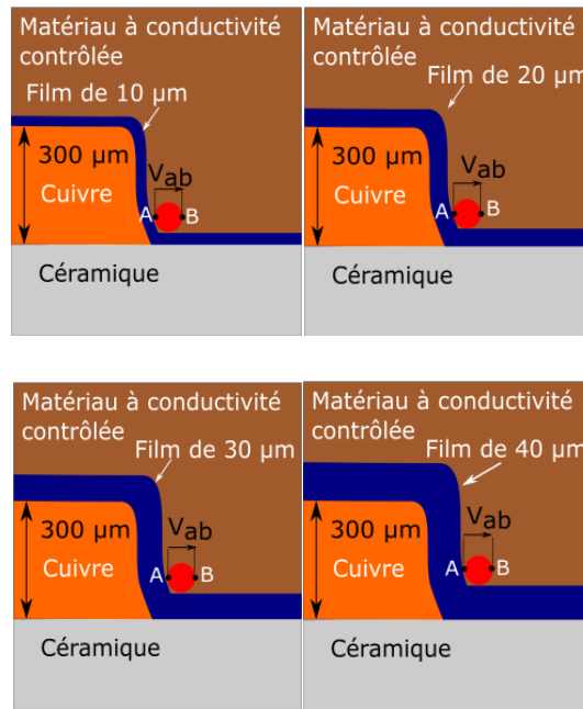
Figure II. 14: Représentation du défaut de 8 \mu\text{m} de diamètre à proximité du point triple dans le matériau à conductivité contrôlée de volume pour les différentes épaisseurs de film
