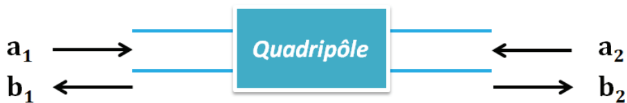
Figure 1.2. Ondes incidentes et ondes réfléchies appliquées à un quadripôle
