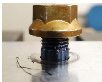
Figure 3.4-1 Copeaux résultant d'un serrage dans les filets imparfaits
