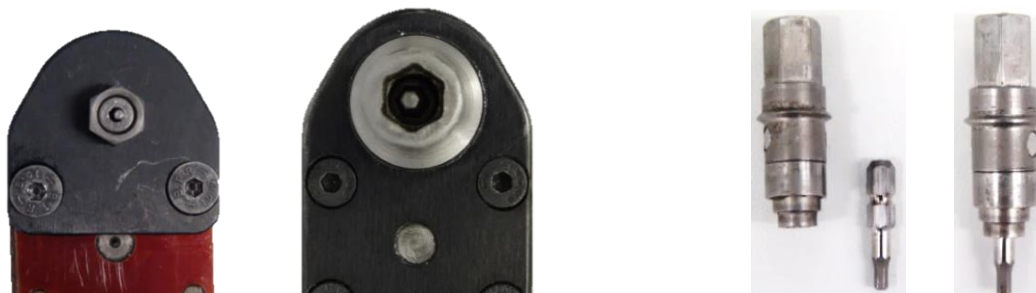
Figure 3.2-3 Douille et immobilisateur
