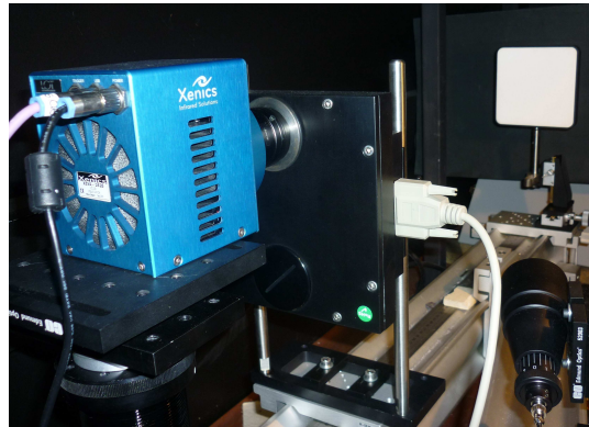
FIG. 4.18 – Configuration étalonnage réflectométrique.
