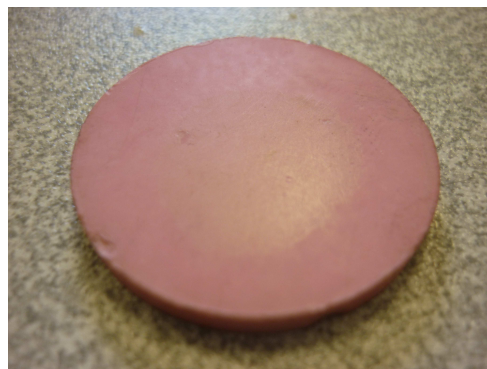
FIG. B.1 – Echantillon d'Oxyde d'Erbium fritté.
