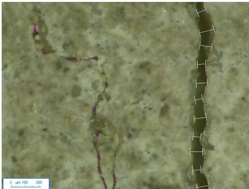
Fig.VI. 5 : Observation au vidéo-microscope (grossissement x175) de deux fissures d'ouverture très différentes, et aperçu de la 'technique des segments' pour la mesure de ces ouvertures.
