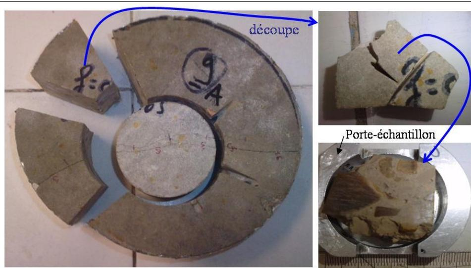
Fig.VI. 7: Découpe d'une galette pour observation au M.E.B.
