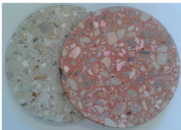
**Fig.V.4 : Galette de béton brute et colorée à la rhodamine.**
