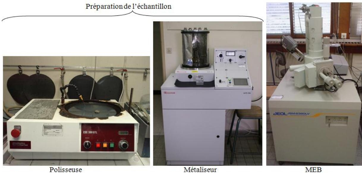
Fig.VI. 8 : Préparation de l'échantillon pour observation au MEB
