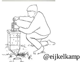
Figure 9. Du micro-simulateur de pluie sur parcelle de 0.25 m 2 à la rampe d'aspersion sur parcelle de 80 m X 5 m.
