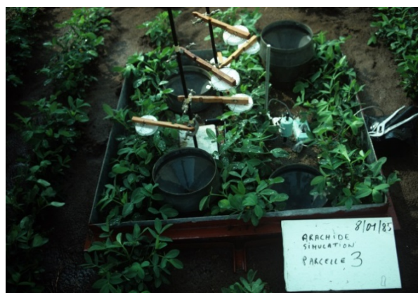
La parcelle de mesure d'1 m 2 équipée de capteurs de spores.
