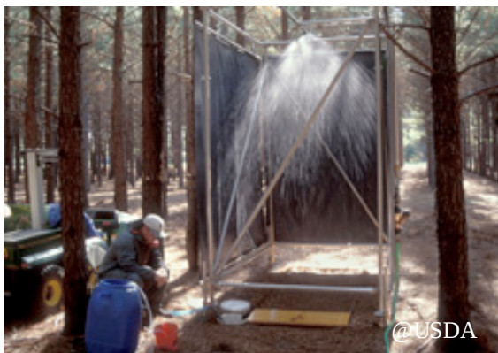
Figure 11. Simulateurs de pluie sur parcelle de 1 m 2 .
