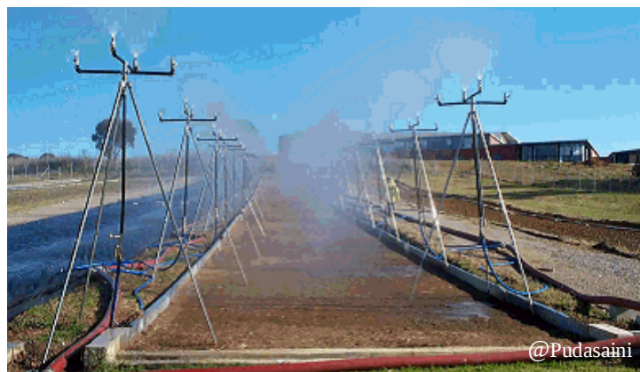
Figure 9. Du micro-simulateur de pluie sur parcelle de 0.25 m 2 à la rampe d'aspersion sur parcelle de 80 m X 5 m.
