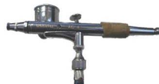
Figure 64 : Pistolet à peinture de type artiste utilisé pour nos dépôts
