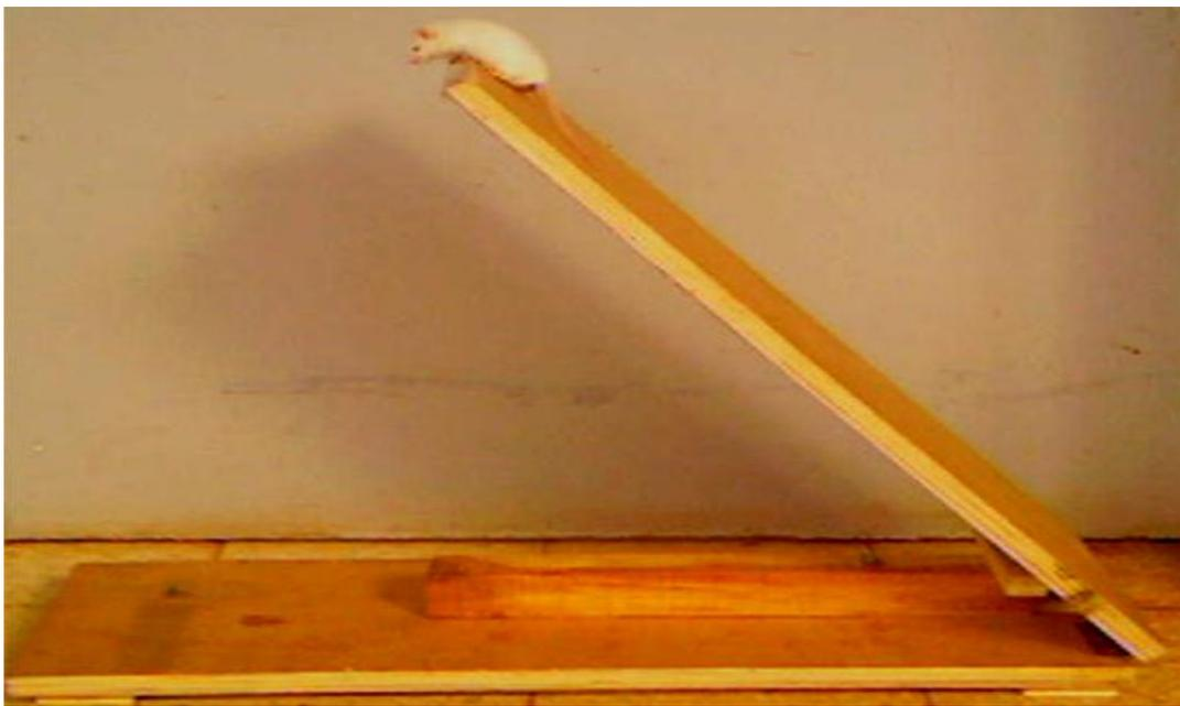
**Figure 2** : Dispositif montrant une souris accrochée au sommet du plan incliné.
